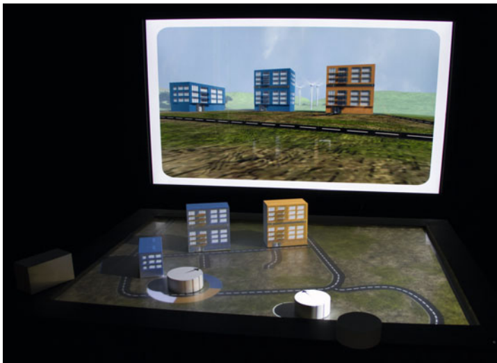
Abb. 12.8: Im Projekt Tangible Urban Planning [Dalsgaard und Halskov, 2014] werden weiße Tangibles auf einem Tabletop durch Projektion mittels zweier Projektoren in Gebäude für Stadtplanungszwecke verwandelt (Foto Jonas Petersen, CAVI, Universität Aarhus, mit freundl. Genehmigung).
