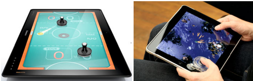
Abb. 12.25: Links: Der Lenovo IdeaCentre Horizon ist ein Multitouch-PC, der auch die Eingabe mit Tangibles unterstützt – hier mit zwei sogenannten Strikern (© Lenovo 2014, mit freundl. Genehmigung). Rechts: Der analoge Joystick FLING als greifbares Zubehör für ein iPad (Quelle: https://tenonedesign.com/fling ), © Ten One Design LLC 2014).
