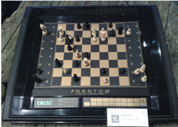
Abb. 12.28: Der Phantom-Schachcomputer von Milton Bradley. Neben berührungsempfindlichen Teilen des Spielfelds ist die Besonderheit das automatische Ziehen (und Schlagen) der Schachfiguren mit Hilfe eines elektromagnetischen Systems.
