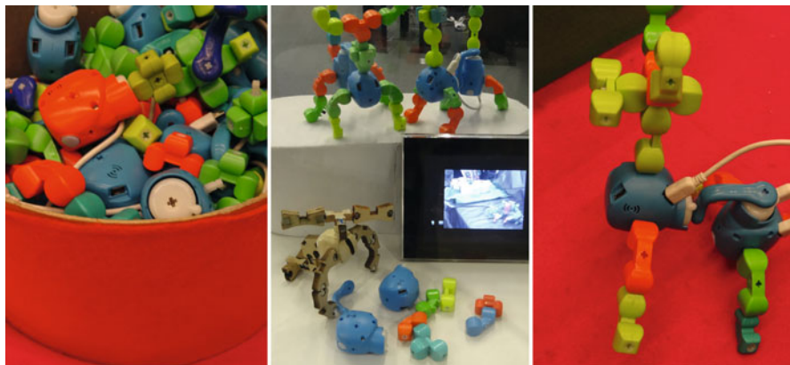
Abb. 12.18: Das elektronische Baukastensystem TOPOBO [Raffle et al., 2004] erlaubt das Zusammenbauen von Kreaturen, die ein kinetisches Gedächtnis haben und vorher vom Nutzer demonstrierte Bewegungen später wieder abspielen können. Die größeren blauen Teile (mittleres Bild, unten) sind aktive Teile.
