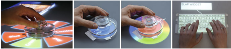
Abb. 12.24: SLAP WIDGETS [Weiss et al., 2009] sind durchsichtige Tangibles, denen man dynamisch verschiedene Funktionen zuweisen kann. Im Beispiel erlaubt der gleiche Drehregler eine Menüauswahl, Werteeinstellung und Farbwahl, und einer Tastatur können verschiedene Belegungen nach Bedarf zugewiesen werden (mit freundl. Genehmigung von Malte Weiß, RWTH Aachen).
