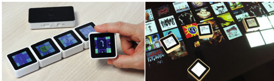
Abb. 12.20: SIFTEO CUBES sind kleine Display-Würfel, die miteinander kombiniert werden können und über verschiedene Sensoren die Bedienung von z. B. Spielen erlauben. Rechts: Die Anwendung CUBEQUERY zum Facetten-basierten Browsen von Medienobjekten auf einem Tabletop. Mit den Sifteo Cubes können Suchparameter einer Datenbankabfrage eingestellt werden, und ihre räumliche Ausrichtung zueinander erlaubt logische Operationen [Langner et al., 2014].
