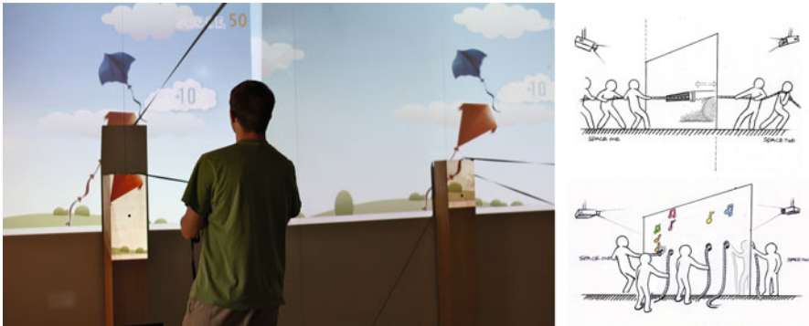
Abb. 12.19: Bei ROPE REVOLUTION [Yao et al., 2011] dient ein reales Seil als physisches Eingabegerät für verschiedene Seilspele mit (teilweise entfernten) Mitspielern (Quelle: http://ropeplus.media.mit.edu/ , mit freundl. Genehmigung von Hiroshi Ishii, Tangible Media Group | MIT Media Lab).
